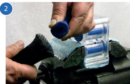
2 Après avoir placé la valve à manchon dans l'outil d'insertion, aplatir la bride sur l'extrémité UP de la vanne.
