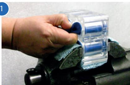
Placer le corps de la vanne à manchon dans un étau rembourré avec le dessous devant toi. saisir et tirer la main l'extrémité inférieure du vanne à pincement.
