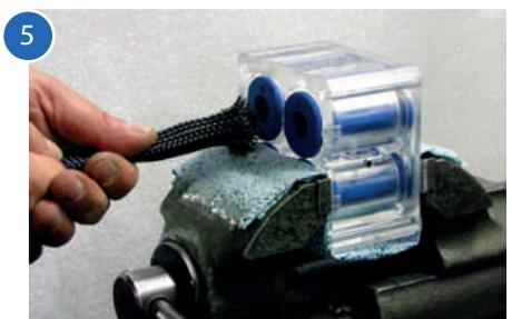
Tirare l'utensile di inserimento attraverso il corpo della valvola, finché l'estremità UP della valvola a manicotto e l'utensile di inserimento escono dal lato superiore del corpo delle valvole a manicotto.
