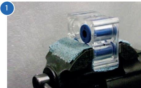
Vire o body of the pinch valves de modo a ter à frente do lado superior.
