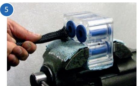
Puxe a ferramenta de inserção através do corpo da válvula, até à extremidade da válvula UP e a ferramenta de inserção para fora do lado superior do the body do pinch valves.
