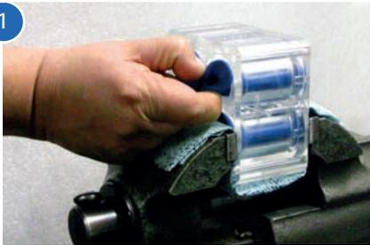
Coloque o pinch valve body numa visão acolchoada com a extremidade inferior virada para si. Agarre e puxe a extremidade inferior da válvula de aperto com uma mão.
