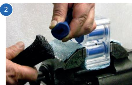
Depois de colocar a válvula na inserção da ferramenta, achane a flange na extremidade da válvula UP.
