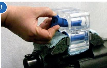
Puxe o pinch valve firmemente até sair do pinch valve body.
