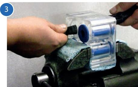
Introduza a extremidade da válvula na ferramenta ALTA para a inserção das válvulas de aperto. Comprimir a extremidade UP do flange e introduza a pequena extremidade na flange achata-da, dentro das válvulas de aperto.
