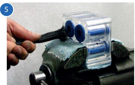
5 Tirez l'outil d'insertion à travers le corps de vanne, jusqu'à ce que l'extrémité HAUT de la vanne à manchon et l'outil l'insertion sort par le côté haut du corps de vanne manchon.
