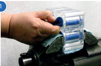
Placer le corps de la vanne à manchon dans un étau rembourré avec le dessous devant toi. saisir et tirer la main l'extrémité inférieure du vanne à pincement.
