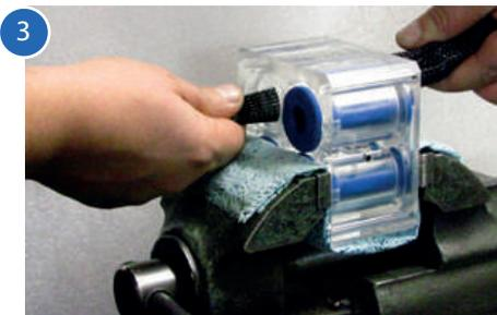
3 Insérez l'extrémité SUPÉRIEURE de la valve dans l'outil pour l'insertion de la valve a manchon. Comprimez l'extrémité UP du bride et insérez l'extrémité petit dans la bride aplatie, à l'intérieur du corps de vanne un manchon.
