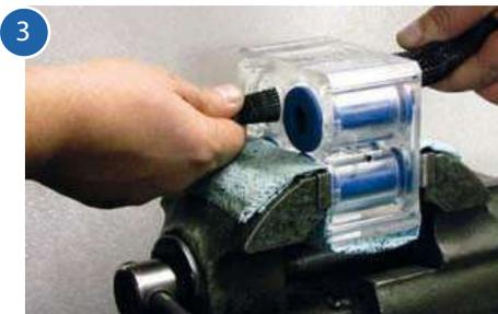
Führen Sie das obere Ende des Ventils in das Werkzeug zum Einsetzen des Quetschventils ein. Drücken Sie das obere Ende des Flansches zusammen und führen Sie das kleine Ende in den abgeflachten Flansch im Inneren des Quetschventilkörpers ein.
