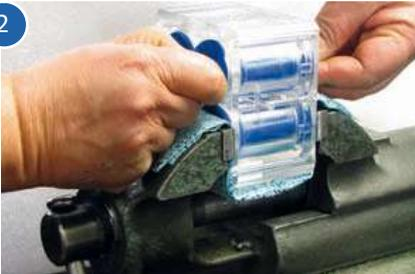
Drücken Sie mit der anderen Hand auf den Flansch am gegenüberliegenden Ende des Quetschventils.
