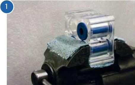
Drehen Sie den Quetschventilkörper so, dass die Oberseite nach oben zeigt.
