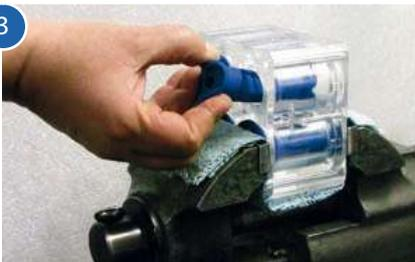
Ziehen Sie am Quetschventil, bis es aus dem Quetschventilkörper herauskommt.
